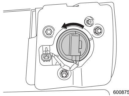
⑤止め金を外し、電球を引き抜きます。
