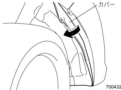
④ カバーを反時計回りに回し、取り外します。
