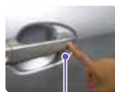
ドアハンドル表面のロックセンサー部に触れる
