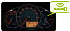
キーレスアクセス&プッシュスタートシステム表示灯が点灯
