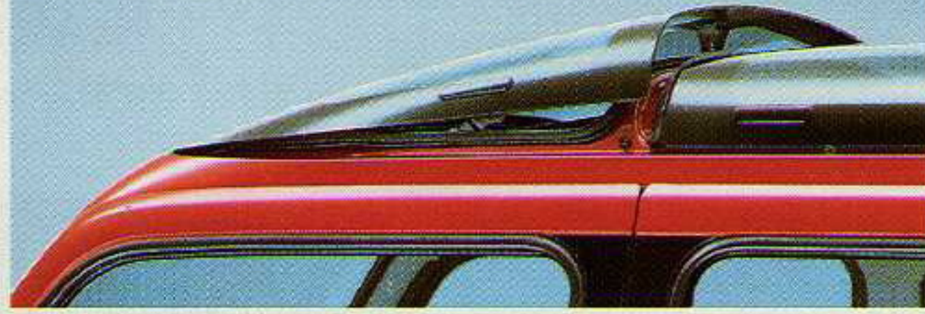
フロントルーフチルトポップアップ機構
