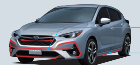
フォグランプ上部にも傾斜面を設け、左右方向の流れがフォグランプベゼルに突き抜けていくようなイメージを創出している。
