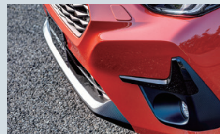
フォグランプ上部にも傾斜面を設け、左右方向の流れがフォグランプベゼルに突き抜けていくようなイメージを創出している。
