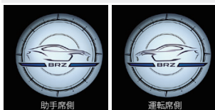
□ウェルカムライト ¥23,320 [¥20,000+税¥1,200] H4617CC000 (S、STI Sport用) ●車両の運転席/助手席ドア下のカーテシランプとの交換取付。 ●運転席/助手席のドアを開くと、LEDでBRZのロゴ&イラストを路面に照射します。 ●路面状態や周囲の光の加減により、明るさ、色味、投影状態が写真と異なる場合があります。
