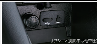
オプション(撮影車は他車種) 外部入力ユニット インパネ(USB/AUX*音声のみ) センタートレイに装着(車両のUSB電源と交換取付)。
