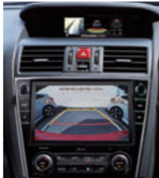
写真はリヤビューカメラ&ディスプレイコーナーセンサー共着・後退時、フロント2センサー接近距離も数値表示します(車庫のフロント/サイドビューモニター&後退時プレーキアシストはマルチファンクションディスプレイ表示)。
