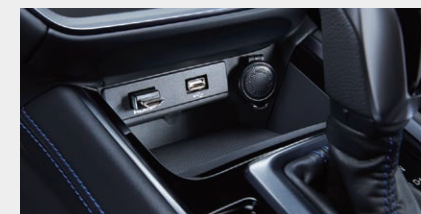
外部入力ユニット インパネ(HDMI/USB) センターレイに装着(車両のUSB電源と交換取付)。
