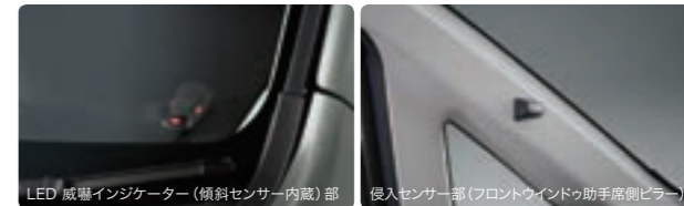
LED 威嚇インジケータ (傾斜センサー内蔵) 部 侵入センサー部 (フロントウインドウ助手席側ヒラー)
