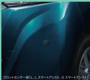
フロントセンサー部(L、L スマートアシスト、G スマートアシスト)
