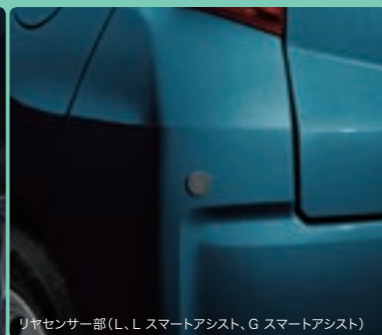
リアセンサー部(L、L スマートアシスト、G スマートアシスト)
