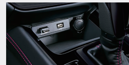
外部入力ユニット インパネ(HDMI/USB) センターレイに装着(車両のUSB電源と交換取付け)。
