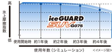
●摩擦係数 氷上試験機にて摩擦係数を計測。(試験条件)アイスガード エスユーヴィ ジーゼロナナゴのキャップコンパウンドの試験片を作成。経過年数見合いで促進劣化後、氷上摩擦係数を計測。水温:-3.0℃、試験場所:横浜ゴム(株)平塚製造所内研究開発センター室内試験機、試験日:2016年4月5日
