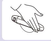
アクセスキーを携帯し、ドアハンドル表面のロックセンサー部(ドアハンドルのくぼみ部)にふれる。
