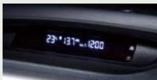
エンジンスイッチが「ON」のとき、外気温度計と瞬間燃費計または平均燃費計 A、B を表示します。
