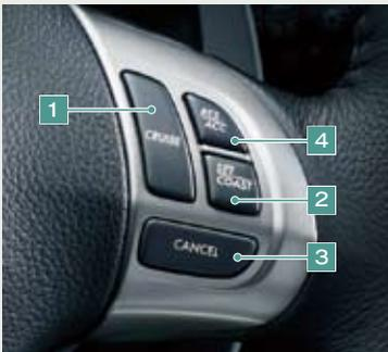
アクセルペダルを踏まなくても車速を一定に保つことができる機能です。CRUISE スイッチ **1** を押しとクルーズコントロールが作動可能になります。作動停止するときはスイッチをもう一度押します。
