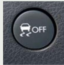
VDC(ビークルダイナミクスコントロール)システムを一時的に「OFF」にしたい場合に押します。作動可能状態に復帰させるときには、もう一度 VDC OFF スイッチを押します。
