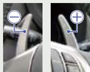
右側のレバーが⊕(アップ)、左側のレバーが⊖(ダウン)になります。1段上のギヤに変速するときは⊕を、1段下のギヤに変速するときは⊖を手前に引きます。
