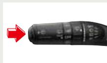
エンジンスイッチが「ON」でライティングスイッチがのとき、スイッチを1秒以上押し、フロントウォッシャーと連動して1秒間作動します。
