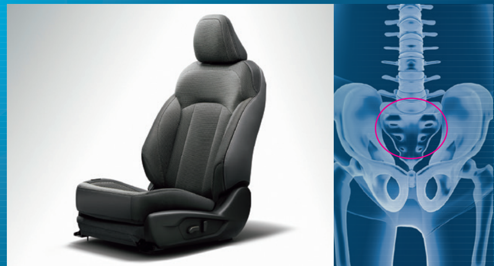
仙骨を押さえ、骨盤を安定させる構造を採用
