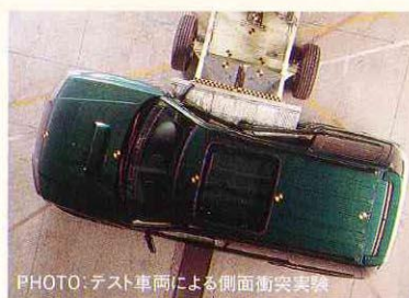
PHOTO:テスト車両による側面衝突実験
