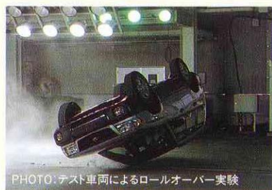
PHOTO:テスト車両によるロールオーバー実験
