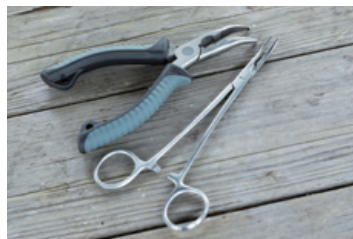
上：プライヤー、下：フォーセップ 先端はハリを外しやすいように曲がっている。
