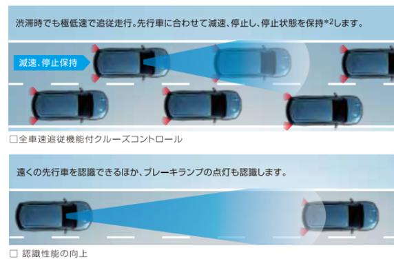
\*1 前方車両との速度差が約50km/h(歩行者の場合は約35km/h)を超える場合は、アイサイト(ver.3)の性能限界から衝突を回避することはできません。また、前方車両との速度差が約50km/h(歩行者の場合は約35km/h)以下であっても、状況によっては衝突が回避できないことやプリクラッシュブレーキが作動しない場合があります。\*2 2分以上停止状態が続いた場合、電動パーキングブレーキを使用した停止保持に切り替わります。この停止保持機能は、電動パーキングブレーキと連動することによって長時間の停止を可能にするシステムです。\*3 車間距離は3段階から設定できます。
