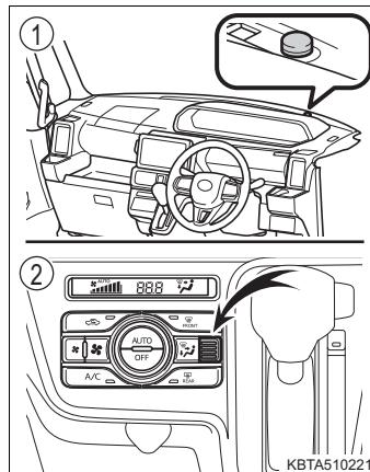
日射センサーの上にものを置いたり、内気センサーをシールなどでふさぐなどすると、センサーが正常に作動しなくなることがあります。
