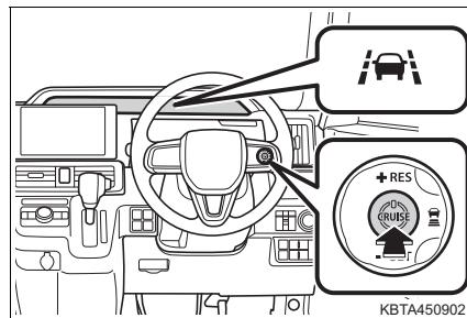
車線中央付近を走行中に作動条件（→ P. 311）をすべて満たすと LKC が作動します。
