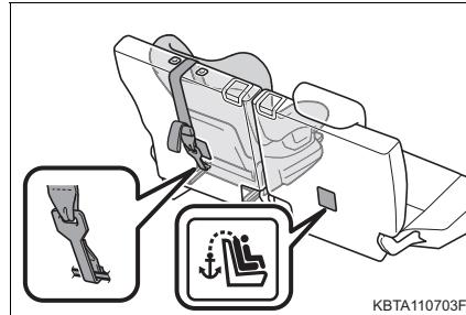
**■ テザーベルトをトップテザーアンカレッジに固定する**
