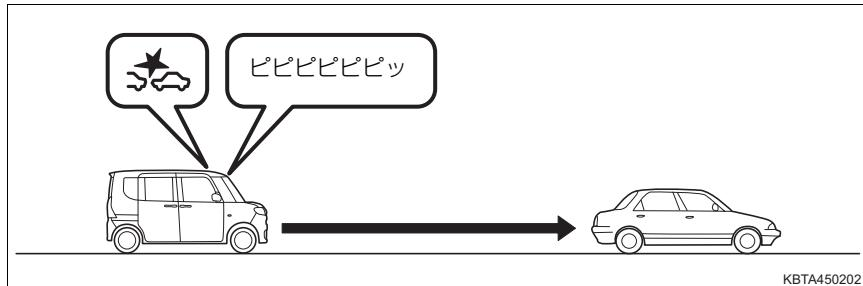
前方車両※・歩行者に対し、衝突の危険性があると判断したときに、ブザーとディスプレイの表示（→ P. 243）で運転者に注意喚起して衝突回避操作を促します。
