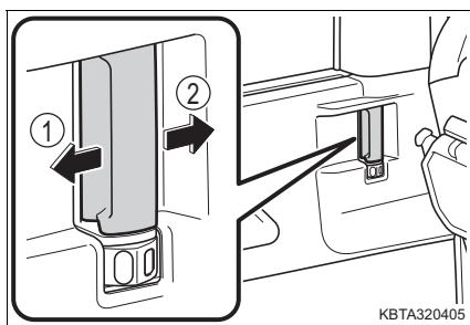
ロックが解除するまで確実にドアハンドルを操作します。
