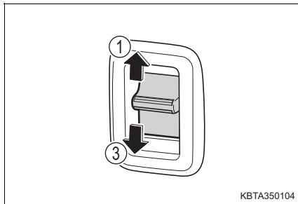
※途中で停止するときは、スイッチを反対側へ軽く操作します。
