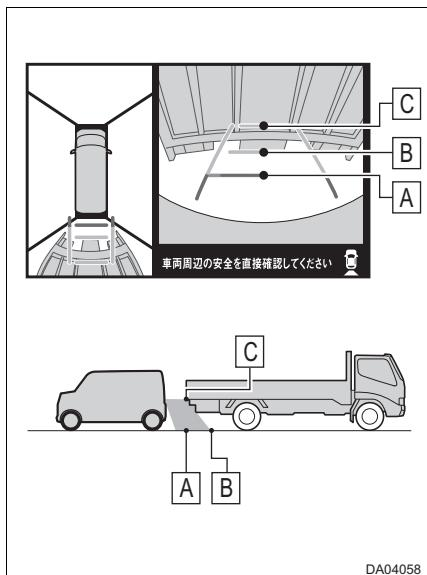
周囲の安全を直接確認してください。画面では、距離目安線より B の位置にトラックが駐車してあるように見えますが、実際には A の位置まで前進、または後退すると、ぶつかります。画面では A、B、C の順に近く見えますが、実際の距離は A と C は同じ距離で、B は A と C より遠い距離にあります。
