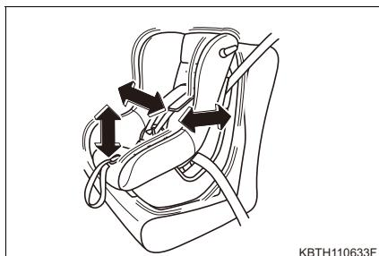
チャイルドシートにシートベルトの固定装置が備わっていない場合は、ロッキングクリップを使用して固定する
