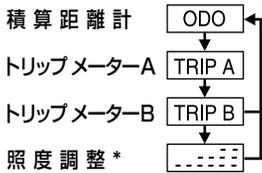
\* 自発光式メーターで、車幅灯が点灯しているときに表示されます。
