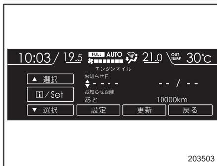
5. 設定が終了したら▲（戻し）▼（送り）スイッチを操作して「設定」を選択し、**i**（インフォメーション） / SETスイッチを引いて決定します。「設定しました」を一定時間表示し、その後、項目選択画面に戻ります。更新ボタンを押すと現在の数値がリセットされます。
