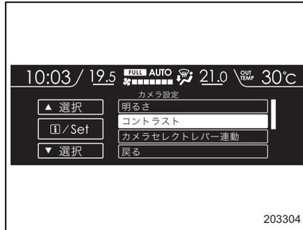
2. ▲ (戻し) ▼ (送り) スイッチを操作してコントラストを調整し、**i** (インフォメーション) / SETスイッチを引いて決定します。決定すると項目選択画面に戻ります。
