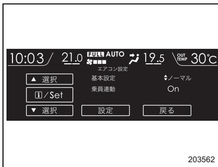
3. 設定が終了したら▲(戻し) ▼(送り) スイッチを操作して「設定」を選択し、**i**(インフォメーション) / SETスイッチを引いて決定します。
