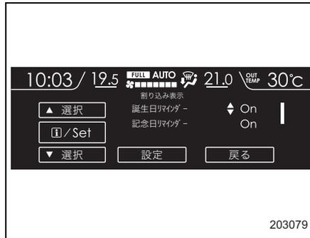
4. 設定が終了したら▲ (戻し) ▼ (送り) スイッチを操作して「設定」を選択し、**i** (インフォメーション) / SETスイッチを引いて決定します。「設定しました」を一定時間表示し、その後、項目選択画面に戻ります。
