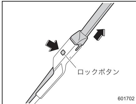
3. ワイパー アームが倒れないように支えながら、新品のワイパー ブレードとアームの接続部を合わせ矢印の方向に押し込みます。ロックボタンが外す前と同じ状態になり、確実に固定されていることを確認します。
