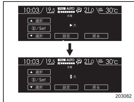
3. ▲ (戻し) ▼ (送り) スイッチを操作してお好みの設定を選択し、**i**(インフォメーション) / SETスイッチを引いて決定します。
