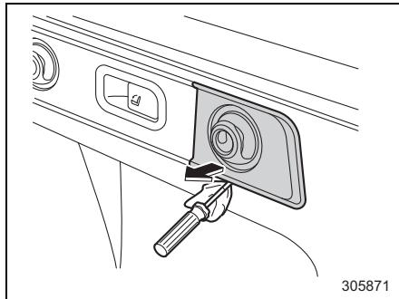
レバーを外して、力を入れずに車両後方へ引く（1センチ位）と解錠します。
