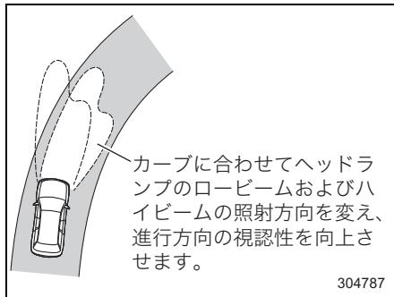
カーブに合わせてヘッドライトのロービームおよびハイビームの照射方向を変え、進行方向の視認性を向上させます。
