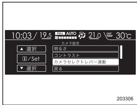
2. ▲ (戻し) ▼ (送り) スイッチを操作して「ON」または「OFF」を選択し、**i** (インフォメーション) / SETスイッチを引いて決定します。
