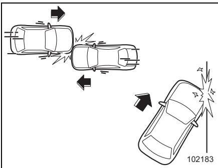
– 駐車している車両など、衝突の衝撃により移動または変形するものに衝突したとき
