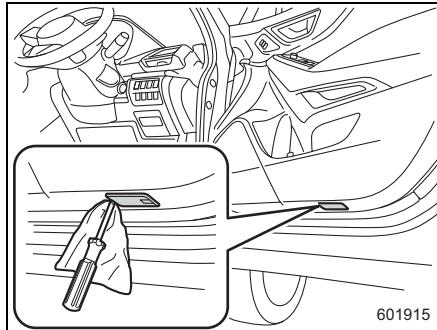
2. コネクターを外してから電球を取り抜きます。
