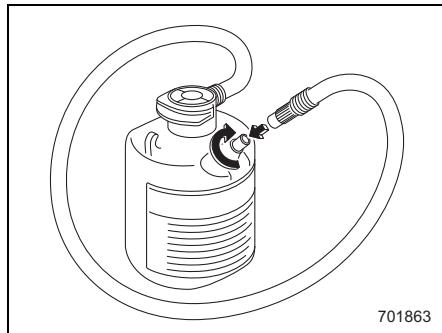
16. パンク修理キットを車両に搭載して直ちに走行します（10分間または5km程度）。走行は法定速度を守って、80km/h 以下の速度で急ハンドルなどを避け、慎重に運転してください。
