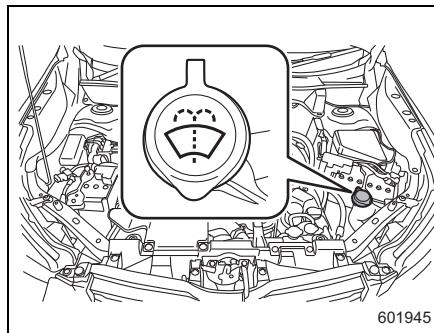
キャップを外し、キャップについているレベルゲージで液量を点検します。
