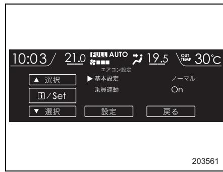
2. ▲ (戻し) ▼ (送り) スイッチを操作してお好みの設定を選択し、**i** (インフォメーション) / SETスイッチを引いて決定します。
