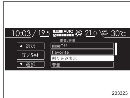
2. ▲ (戻し) ▼ (送り) スイッチを操作して表示を変更したい項目を選択し、**i**(インフォメーション) / SETスイッチを引いて決定します。
