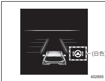
(Ⓐ) (レーンキープ) スイッチをもう一度押すとOFFになります。EyeSight表示部の “(Ⓐ)” (レーンキープ表示灯) が消灯します。
