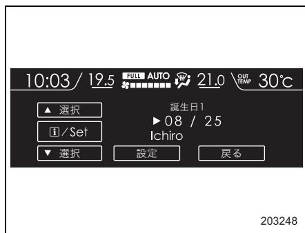
4. ▲（戻し）▼（送り）スイッチを操作して数字または文字を切り替え、**i**（インフォメーション）/SETスイッチを引いて決定します。決定すると手順3.の表示に戻ります。
