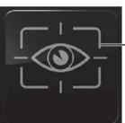
灰色<br>403133 | —※                                          | ドライバーモニタリングシステム OFF 状態 / ドライバーモニタリングシステム故障状態 |
