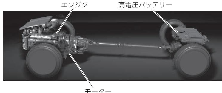
アクセルペダル、ブレーキペダルの操作や車速など、車の状況に合わせて、ガソリンエンジンは自動的に停止・再始動します。
