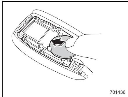
5. 凹凸を合わせてカバーを取り付けます。
