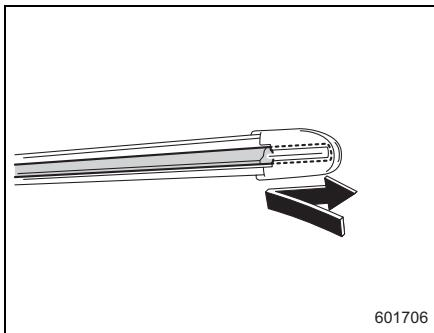
5. ブレードラバーが確実に固定されていることを確認します。
