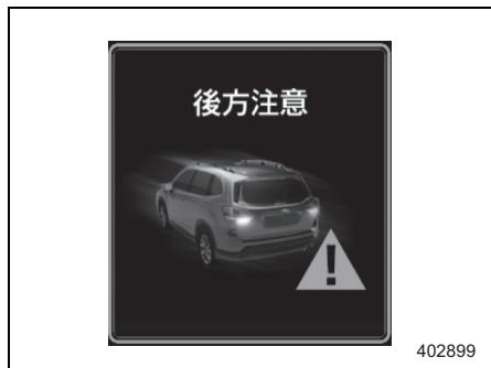
システムによる自動ブレーキで停車した後は、安全のためブレーキペダルを踏んでください。ブレーキペダルを踏むまでマルチファンクションディスプレイとマルチインフォメーションディスプレイに割り込み画面が表示され、ブザー（ピ――）が鳴ります。
