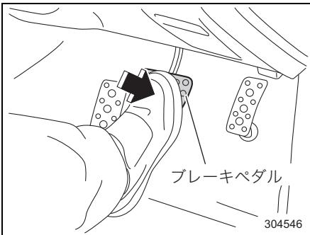
4. ブレーキペダルを確実に踏んだまま、ブッシュエンジンスイッチを押します。エンジンが始動するまでブレーキペダルを踏み続けてください。e-BOXERシステムが作動すると、メーター内の走行可能(READY)表示灯が点灯します。
