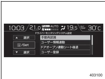
2. ▲ (戻し) / ▼ (送り) スイッチを操作して「はい」を選択し、**i** (インフォメーション) / SETスイッチを引いて決定し、スキャン画面を表示します。
