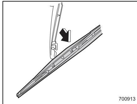
3. ワイパーームに、新品のワイパープレードを取り外しの逆手順で取り付けます。
