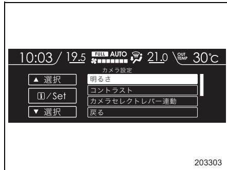
2. ▲ (戻し) ▼ (送り) スイッチを操作して明るさを調整し、**i** (インフォメーション) / SETスイッチを引いて決定します。決定すると項目選択画面に戻ります。
