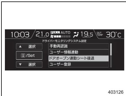
2. ▲ (戻し) / ▼ (送り) スイッチを操作して「ON」を選択し、**i** (インフォメーション) / SET スイッチを引いて決定します。
