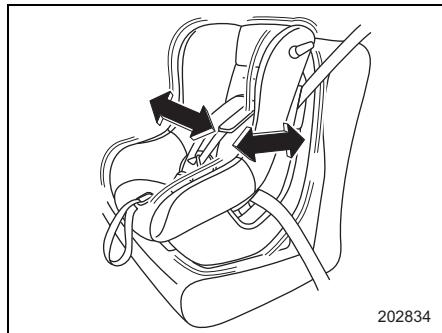
チャイルドシートにシートベルトの固定装置が備わっていない場合は、ロッキングクリップを使用して固定します。
