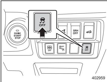
TCS機能が解除されるとメーター内のVDC OFF表示灯が点灯します。復帰させるときにはもう一度VDC OFFスイッチを押します。
