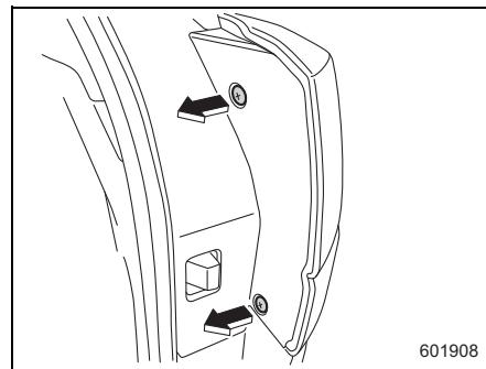
2. カバーの車両内側を押しながら、カバーとランプ本体のすき間に指を入れ、手前に引いてカバーのツメを外します。
