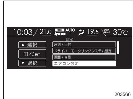
1. ▲（戻し）▼（送り）スイッチを操作して設定する項目を選択し、**i**（インフォメーション）／SETスイッチを引いて決定します。
