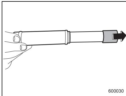
3. 本体の先端を、キャップ頭部のすり薬でこすると着火します。
