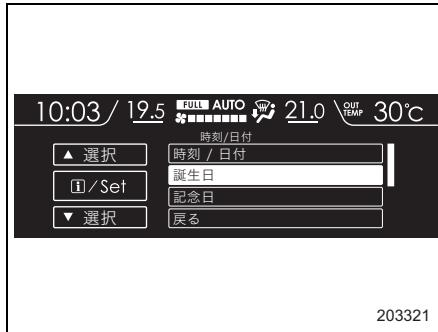
2. リストに登録する場所を▲（戻し）▼（送り）スイッチを操作して選択し、**i**（インフォメーション）／SETスイッチを引いて決定します。
