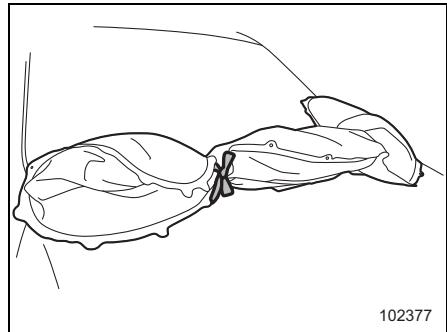
4. エアバッグ本体のガスを抜いて丸め、結んだストラップの輪の中に押し込みます。
