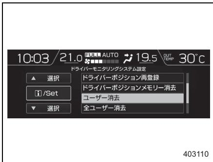
2. ▲ (戻し) / ▼ (送り) スイッチを操作して「1」を選択し、**i** (インフォメーション) / SETスイッチを引いて決定します。
