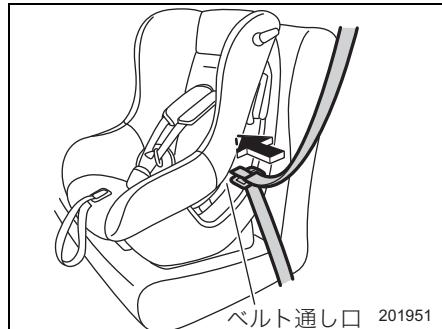
5. シートベルトのタングプレートをバックルの中へ、“カチッ”と音がするまで差し込みます。
