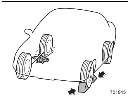
6. ジャッキは、交換またはタイヤチェーンを脱着するタイヤに近いジャッキアップポイントの下に置きます。ジャッキ頭部の溝が車体のジャッキアップポイントにはまるまでジャッキハンドル取り付け部を手で回します。
