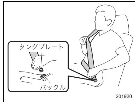
3. 正しい姿勢で腰掛け、腰のベルトを腰骨のできるだけ低い位置に密着させます。
