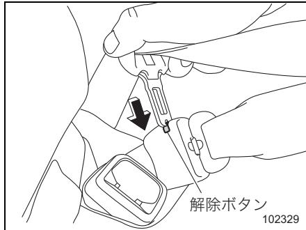
2. シートベルトを巻き取り、コネクターをカーゴルームの格納ホルダーに差し込み固定します。
