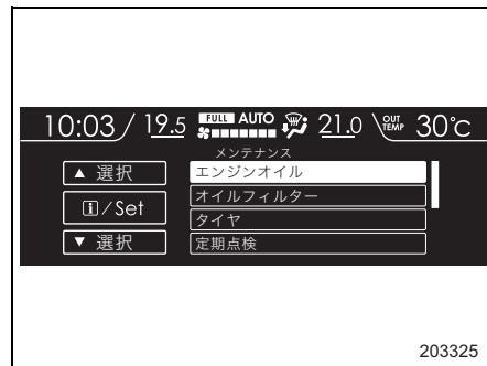
2. 設定する項目を▲（戻し）▼（送り）スイッチを操作して選択し、**i**（インフォメーション）／SETスイッチを引いて決定します。
