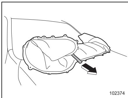
2. エアバッグ本体をめくり上げ、ボンネット側の布にあるスリットにストラップを通します。
