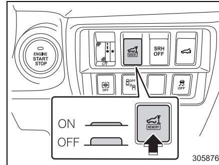
3. パワーリヤゲートをお好みの高さにし、その状態を保ちながらパワーリヤゲートインナースイッチを押し続けます。登録が完了するとブザー（ビピーッ）が鳴り、同時に非常点滅表示灯（ハザードランプ）が3回点滅します。
