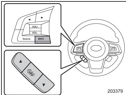
2. ▲（戻し）▼（送り）スイッチを操作して設定メニューを切り替えます。
