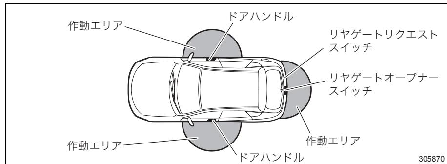
ドアが施錠している状態で前席のドアハンドルの作動エリアに入ると、アクセスキーのLEDの表示灯が点滅します。
