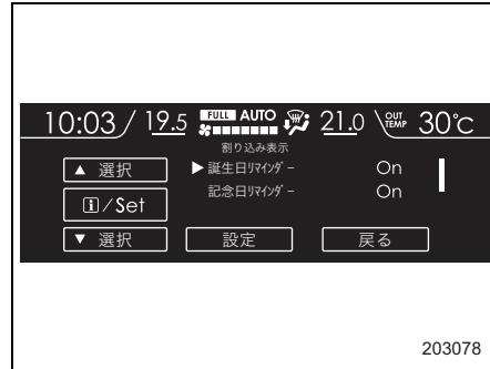
3. ▲ (戻し) ▼ (送り) スイッチを操作して「ON」または「OFF」を選択し、**i** (インフォメーション) / SETスイッチを引いて決定します。
