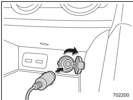
10. タイヤの側面に亀裂や傷、へこみがないことを確認し、コンプレッサーの電源スイッチを ON にして修理剤と空気を注入します。
