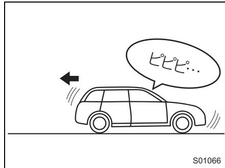
後退飛び出し抑制が作動すると、ブザー(ピピピ...)が鳴ります。また、マルチインフォメーションディスプレイに割り込み画面を表示します。
