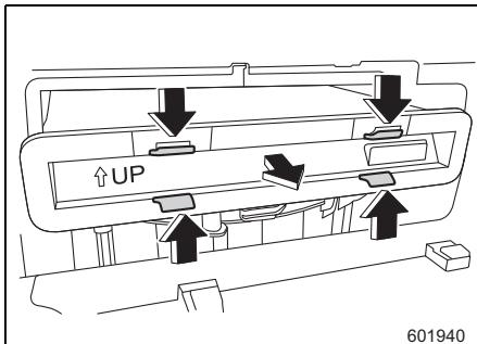
5. エアコンフィルターの手前を下に傾けてゆっくり引き出します。
