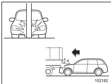
– 片側衝突（オフセット衝突）したり、斜め前方へ衝突したとき
