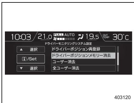
2. ▲ (戻し) / ▼ (送り) スイッチを操作して「はい」を選択し、**i** (インフォメーション) / SETスイッチを引いて決定します。
