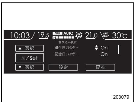
4. 設定が終了したら▲ (戻し) ▼ (送り) スイッチを操作して「設定」を選択し、**i** (インフォメーション) / SETスイッチを引いて決定します。
