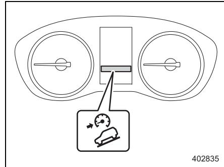
マルチファンクションディスプレイを予防安全画面にしている場合、メーター内の表示灯に連動してヒルディセントコントロール作動表示が点灯・点滅します。
