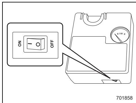
23. タイヤの空気圧が黄色のゾーンのときは、タイヤの指定空気圧まで空気を入れます。
