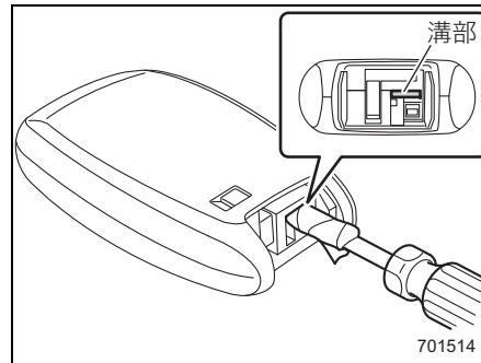
3. 電池と基板の間に絶縁テープなどを巻いたマイナスドライバーを差し込んで、電池の上側を押さえながら電池を抜き取ります。
