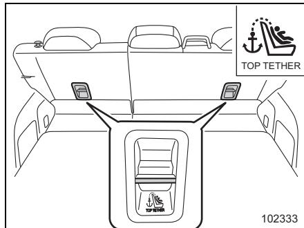
テザーベルトのフックを、図のようにトップテザーアンカレッジに引っかけます。
