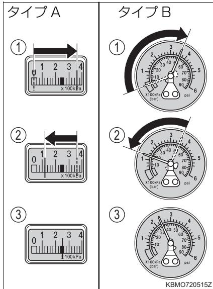
**[17] 指定の空気圧まで昇圧できれば、コンプレッサーの電源を“OFF”にする**
