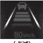
(点滅) | 手放し注意が行われている状態から、さらに車線逸脱抑制制御機能が作動し、手放し運転警告が行われた<br>※2              |
