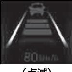
(点滅)  | 手放し運転をしているとシステムが判断しているとき、車線逸脱抑制制御機能が約3分の間に2回以上作動し、手放し注意が行われた<br>※2 |
