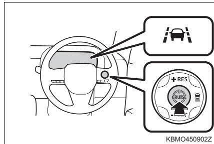
車線中央付近を走行中に作動条件（→ P. 324）をすべて満たすと LKC が作動します。
