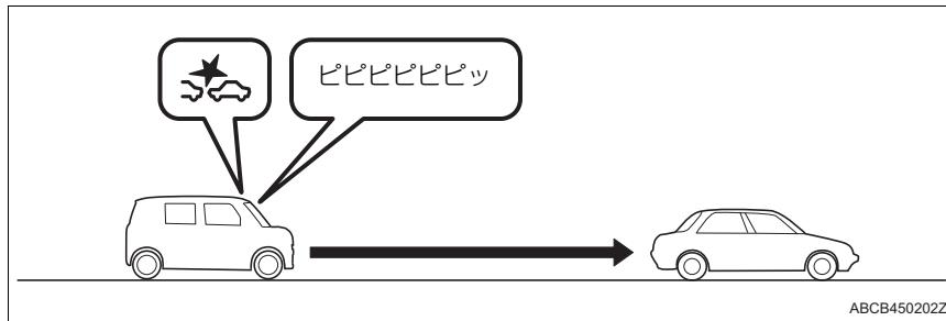
前方車両※・歩行者に対し、衝突の危険性があると判断したときに、ブザーとディスプレイの表示（→ P. 255）で運転者に注意喚起して衝突回避操作を促します。
