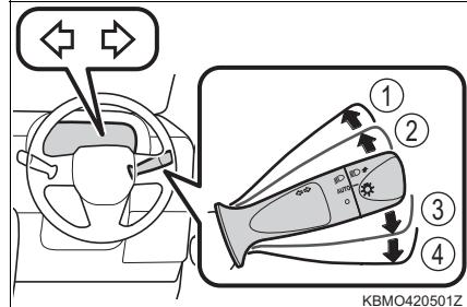
\* ② または ③ の位置にレバー操作し、すぐに離したときは方向指示灯が 3 回点滅します。
