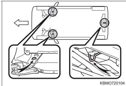
鎖やケーブルなどを使用して車両を固縛する場合は図に黒く示す角度が目安で 45° になるように固縛する
