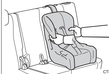
取り付けたチャイルドシートを軽くゆさぶり、確実に取り付けられていることを確認する
