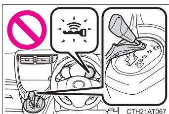
セレクトレバーが P の位置にあるか確認してください。エンジンを始動するときに、セレクトレバーが傾いたり、P 以外の位置にするとステアリングロック機能が作動しエンジンを始動することができないことがあります。キーレスアクセス＆プッシュスタートシステム表示灯が緑色に速く点滅します。
