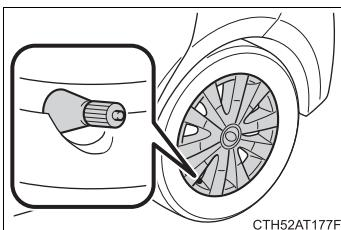
タイヤのバルブ（空気口）に切り欠きを合わせてホイールキャップを確実に取り付けてください。
