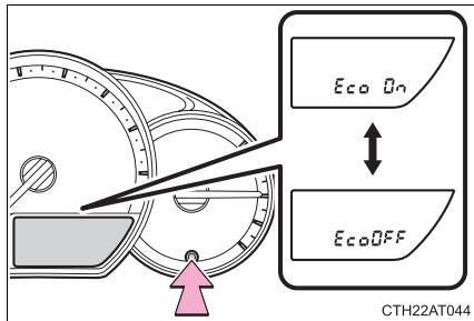
Info-ECO（インフォ・エコ）表示灯の点灯／消灯を変更するには、Info-ECO（インフォ・エコ）表示灯ユーザーカスタマイズ画面表示中に、トリップ切り替え／トリップリセットノブを押します。
