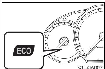
Info-ECO（インフォ・エコ）表示灯が点灯すると、環境に配慮した運転をしていることを知らせます。必要以上にアクセルペダルを踏むと消灯します。
