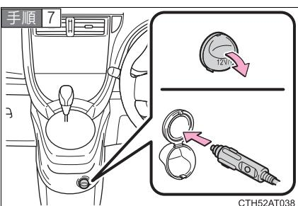
コンプレッサーの電源プラグをアクセサリーソケットに差し込む
