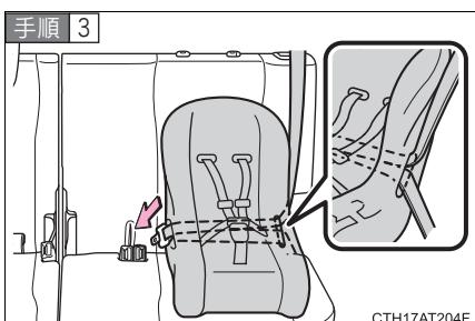
チャイルドシートにシートベルトを取り付け、プレートをバックルに“カチッ”と音がするまで差し込む。ベルトがねじれていないうるようにする
