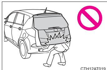
● 半開状態で使用すると、リヤゲートが落ちて重大な傷害を受けるおそれがあります。特に傾斜地では、平坦な場所よりもリヤゲートの開閉がしにくく、急にリヤゲートが開いたり閉じたりするおそれがあります。必ずリヤゲートが全開で静止していることを確認して使用してください。
