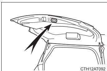
リヤゲートハンドルを持ってリヤゲートを引き下げ、必ず外から押して閉めてください。
