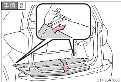
カーゴフロアのボードを溝に沿って下げ、手前に倒す。
