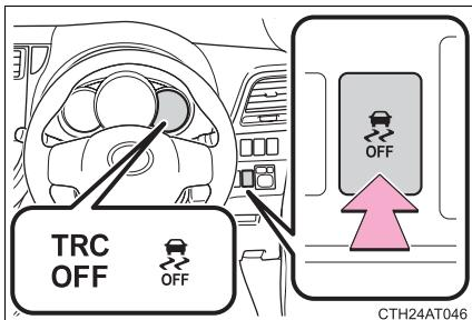
TRC<sup>\*</sup>とVDCを停止するには停車時にスイッチを押し3秒以上保持する
