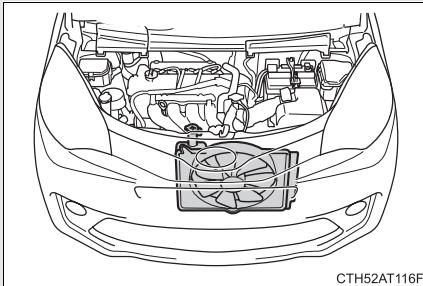
手順 5] 冷却水が不足している場合は、冷却水を補給する (→P. 320)
