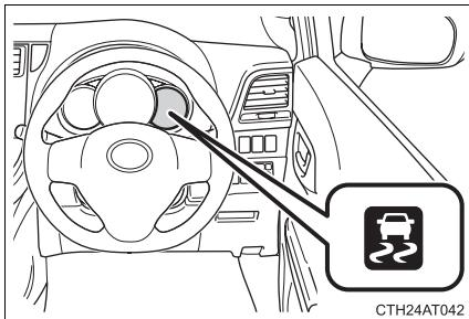
VDC、TRC<sup>\*</sup>が作動しているときはVDC作動表示灯が点滅します。
