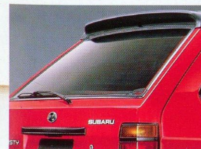
リヤワイパー&熱線プリントリヤデフォグガー(Lを除く)
