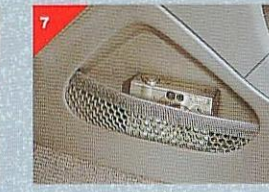
7 助手席足元サイドポケット 助手席側の足元に設けた、ネットタイプの小物収納ポケット。
