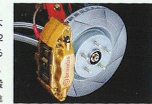
[スリット入り専用4輪ベンチレーテッドディスクローター]
