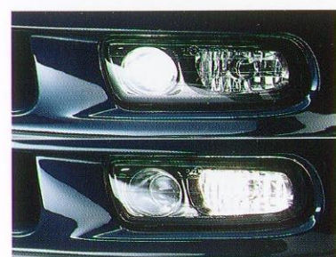
プロジェクターフォグランプ (GT-B,GT,250T,TStyleR) & コーナリングランプ
