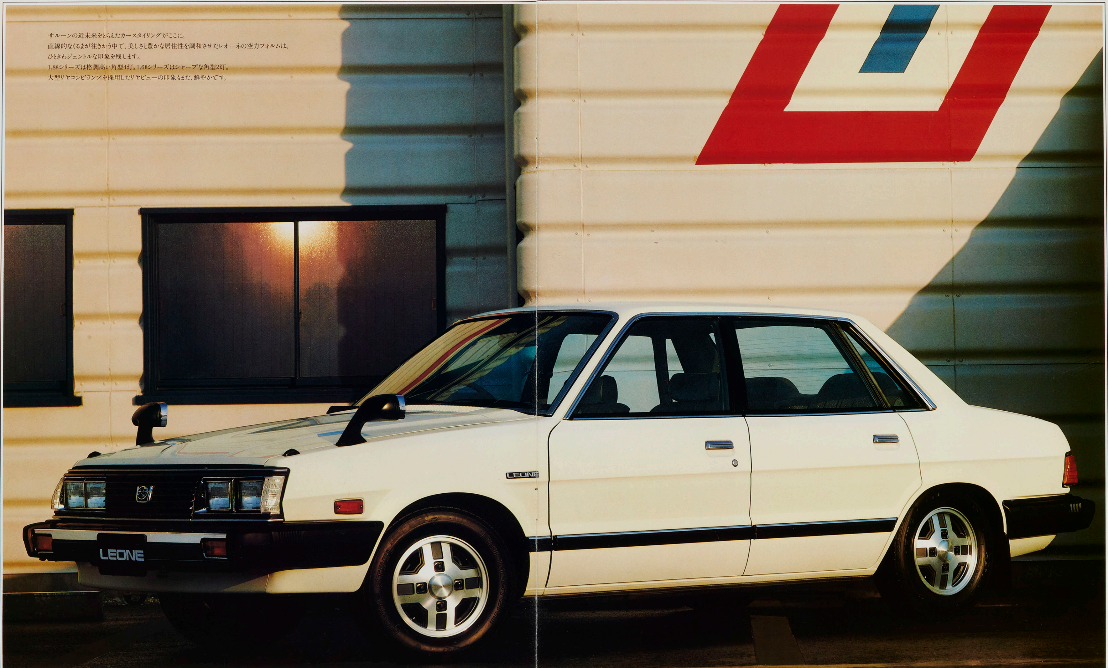
エアロダイナミック・レオーネ ● 全高の低い水平対向エンジンが可能にしたスラントノーズと低いフロントフードライン ● 揚力をおさえるフロントエアダムスカートとスバルFF方式特有の凹凸の少ないボディフロア設計 ● 横風をいなすタンブルホーム ● 風圧をかわす、スラントノーズとスリークなボディ
