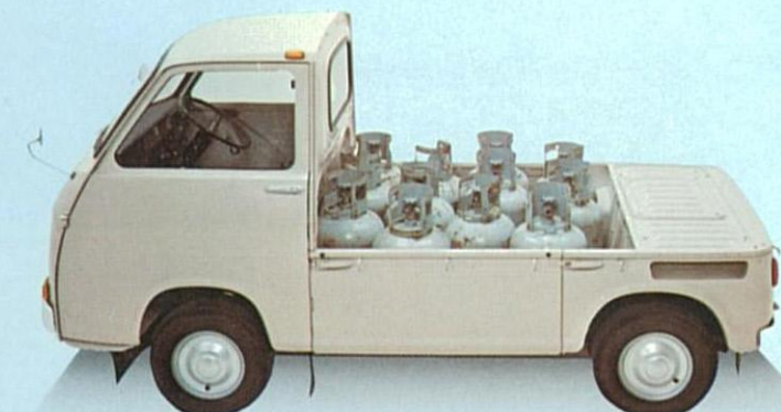
▲トラック(低床式) LPガスボンベ 27本 直径 高さ 31cm × 49.5cm (満タンの場合)
