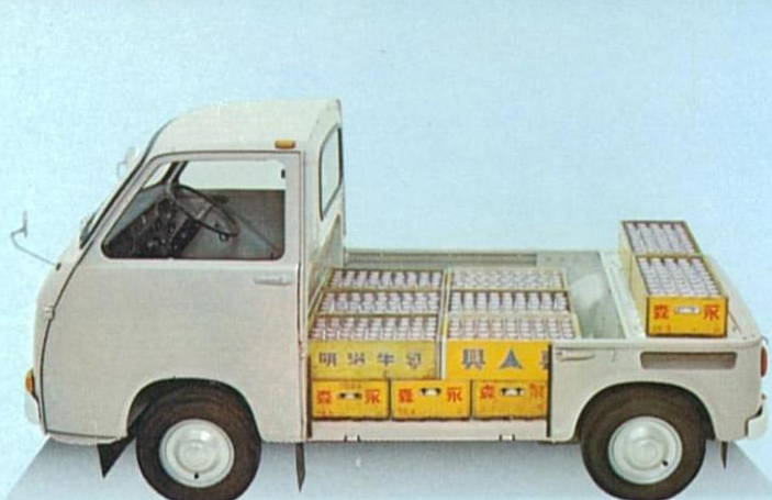
▲トラック(低床式) 牛乳箱 16箱 45本入り木箱 高さ 56.5cm × 32.5cm × 16.5cm
