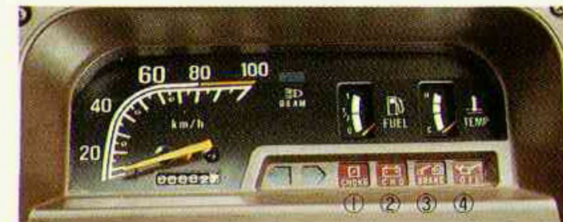
①チョークパイロットランプ ②チャージウォーニングランプ ③パーキング&ブレーキフルード液面警告灯 ④エンジンオイル残量警告灯
