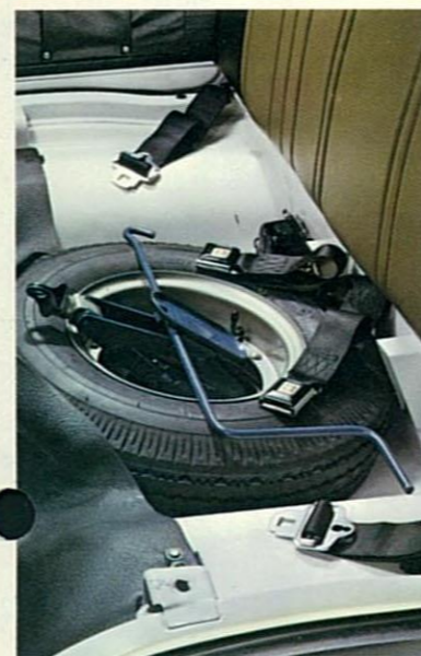
●泥に汚れず、取りはずしの簡単なシート下スペアタイヤ
