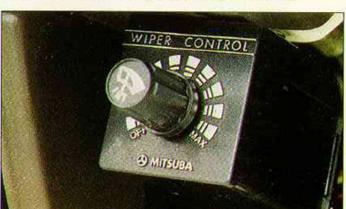
ワイパーコントロール: ローからハイスピードまで、状況に応じたワイパー速度が選べます。
