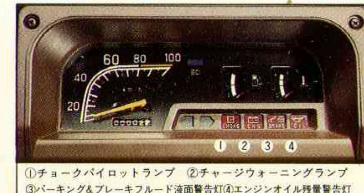
①チョークパイロットランプ ②チャージウォーニングランプ ③パーキング&ブレーキフルード液面警告灯 ④エンジンオイル残量警告灯
