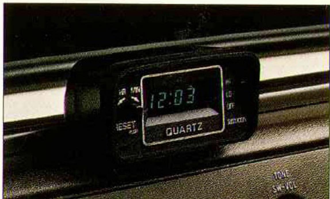
デジタルロック: 高性能の水晶発振式。分きざみの正確な時間が、ひと目で読みとれます。
