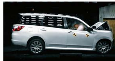
テスト車両による衝突実験
