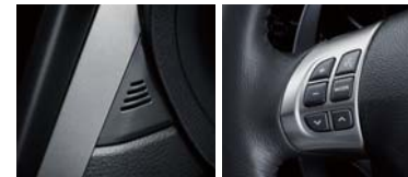
音声認識用マイク/ オーディオリモートコントロールスイッチ
