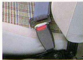
フロントシートベルト シート一体アンカーなのでシートを動かしてもシートベルトの取り付け高さを調節できる。クセウレピングランプ付(5.5系系車)
