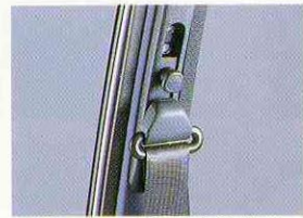
フロントシートベルトショルダーアジャスター (3ドアセダンの3ドアバンを除く) シートベルトの取り付け高さを調節できるので、小柄な人でもぴったりフィットします。
