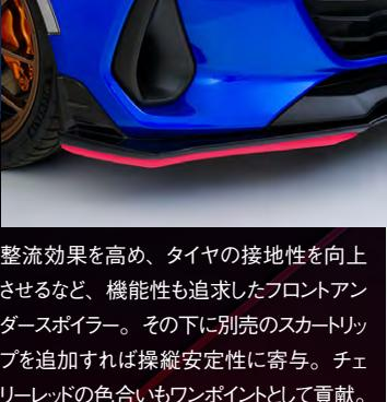
整流効果を高め、タイヤの接地性を向上させるなど、機能性も追求したフロントアンダースポイラー。その下に別売のスクートリップを追加すれば操縦安定性に寄与。チエリーレッドの色合いもワンポイントとして貢献。
