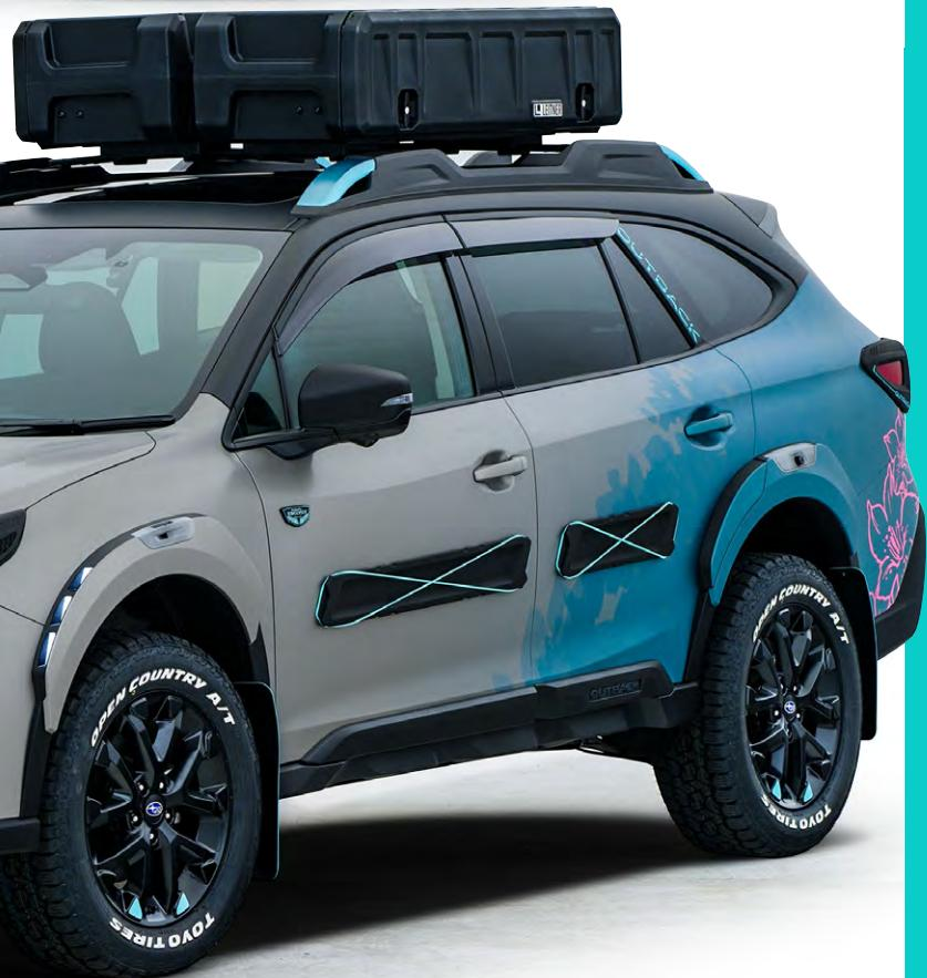
色の境目は葉っぱをモチーフとし、ブーストギアが持つアクティブライトスタイルに違和感なくハマる。またコンセプトモデルに相応しい、個性的で最先端な技法にも注目。フェンダーは視覚的に車幅をワイドに見せるLEDアクセサリーライナーを仕込み、上部にユーチャーが用途に合わせてアレンジ可能なアクセサリースポットを採用。最先端技術の粉末造形3Dプリンターで製作したアタッチメントをばめ込めば、機能性が大きく向上する。グリルも同じく3Dプリンターを活用して、複雑なディテールの表現が可能となつた。
