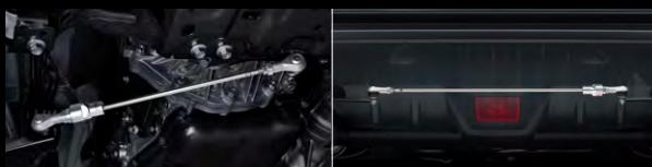
わずかな「遊び」や「ガタ」を修正し、車両の挙動の一体感向上、走行安定性などの効果が狙えるフレキシブルドロースティフナーを前後に標準装備。
