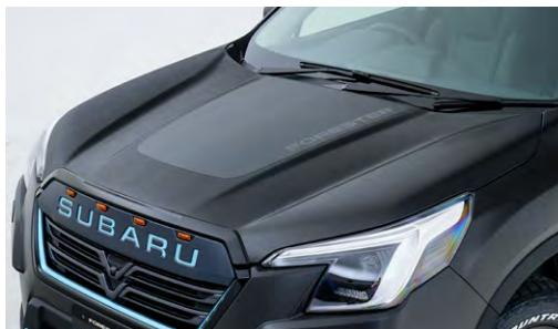
前回のクロストレックとはひと味違ったダークな色合いだが、質感は同じヘアライン調にすることでブーストギアの世界観を揃える。イサム塗料と共同開発したキズ付き防止塗装は悪路だけでなく、普段使いでもヒットしやすい部分にも施工している。
