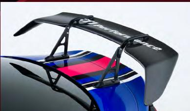
スーパーGTのマシンでも象徴的なスワンネック形状のリヤスピーカー。素材は軽量なドライカーボン製で、角度は2段階調整式。
