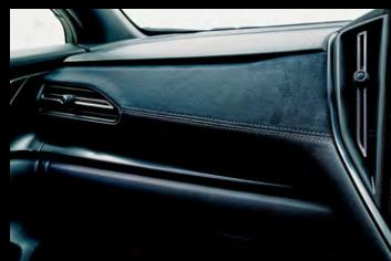
インパネミッドトリムとドアトリムに、シルバーステッチ付スエード調加飾を配することで、高級感を高めている。
