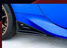
サイドアンダースポイラーは、ボディ下部から車体を押し上げようとする空気をスムーズに後方へと流す。
