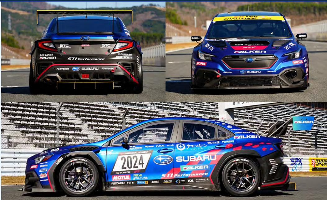
フロントアンダーパネルの形状改良やリアウイング翼端板の拡大など空力向上を狙ったアップデートに加え、ボディサイドに大きく描かれているチェックーデザイン部は、新たに日本の「桜」を感じさせるデザインをプラス。
