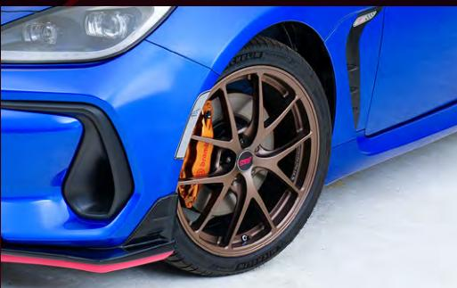
モータースポーツのノウハウを生かしたBBS製の鍛造1ピースホイール。デザインもスーパーGT参戦車両のホイールから踏襲される。
