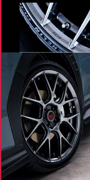
「STI 製フレキシブルパフォーマンスホイール」は、前後異なる形状のため「FRONT」、「REAR」の刻印が施されている。BBS 製の鍛造ホイールで、スーパーブラックハイラスター塗装を採用。サイズは19インチ×8.5J。タイヤは、245/35R19 のミシュラン・パイロットスポーツ5を履く。
