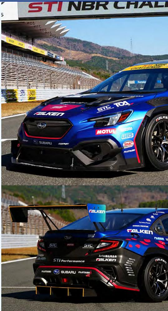
旋回性能を大きく飛躍させる「STI フレキシブルバーマンスホイール」を新採用。前後微妙に異なる形状とすることで限界性能を高めている。さらには空力向上を狙ったトランクスポイラーなど、限定車「WRX S4 STI Sport #」にも活かされている装備は、ニュルでの開発が大きく関わっている。
